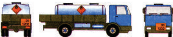
Εικ. 86 Τοποθέτηση πινακίδων αναγνώρισης υλικού και ετικετών κινδύνου σε όχημα που φέρει αποσπώμενο βυτίο με εύφλεκτα υγρά.
