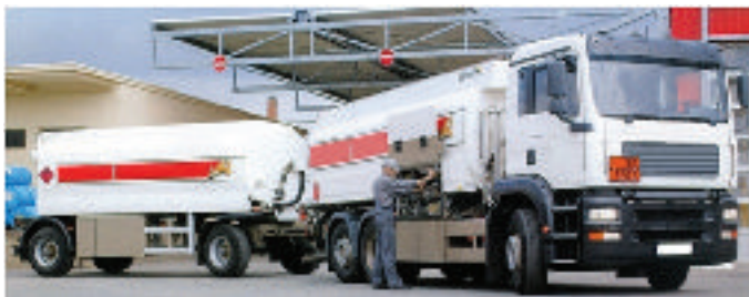
Εικ. 55 Οδικός συρμός αποτελούμενος από ρυμουλκό βυτιοφόρο και ρυμουλκούμενο βυτιοφόρο.
