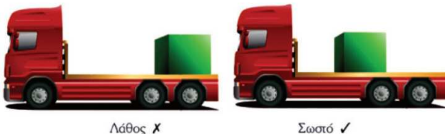
Εικ. 38 Κατά μήκος της πλατφόρμας τοποθέτηση φορτίου.
